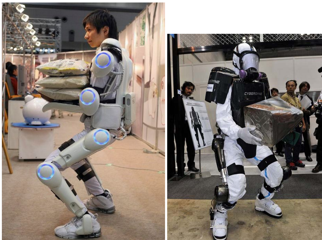
Рис. 5. Экзоскелет HAL, Cyberdyne Corporation, Япония. Слева обычного исполнения, справа для аварийно-спасательных работ [3, 7]
