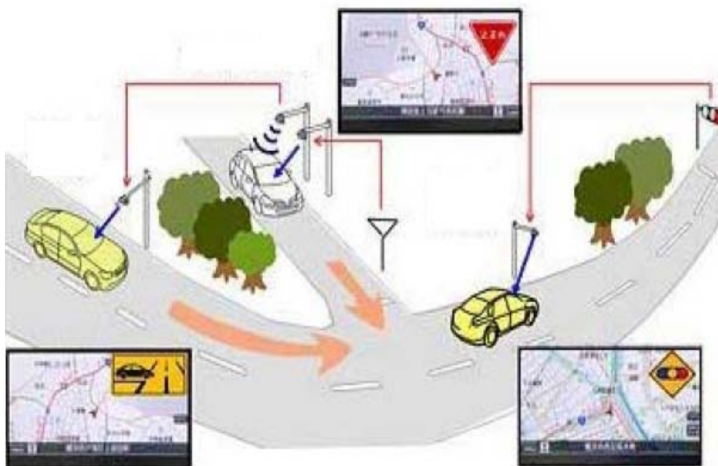
Рис. 4. Схема информационно-телекоммуникационной системы на примере участка улично-дорожной сети
