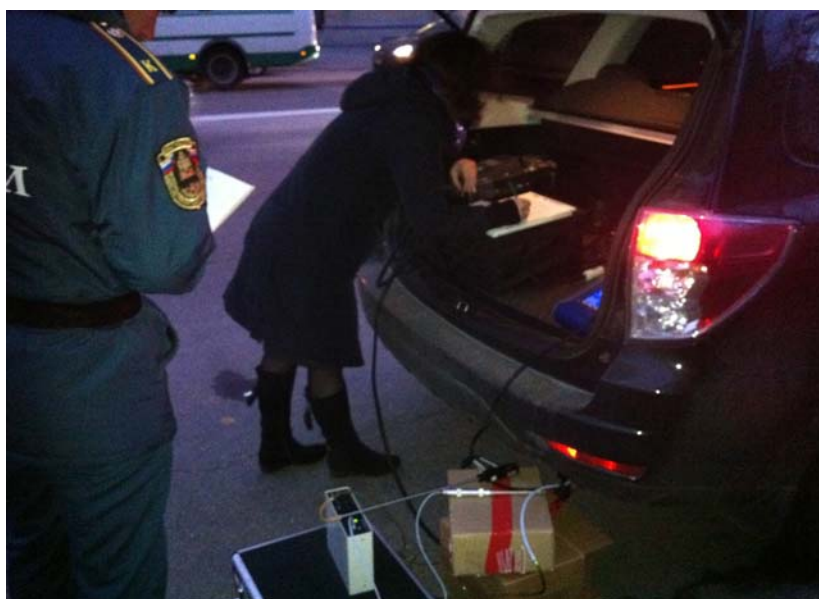
Рис. 2. Измерение выбросов ЗВ при пуске и прогреве двигателя автомобиля
